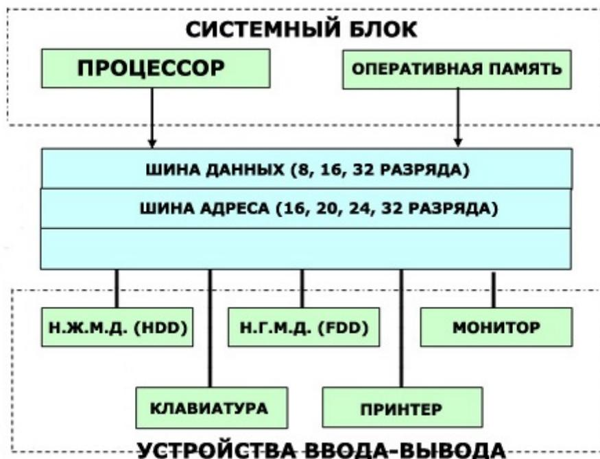
Разрядность шины данных определяется разрядностью процессора (т.е. количество двоичных разрядов, которые процессор обрабатывает за один такт). Шина данных двунаправленная от процессора к устройству и наоборот. Код адреса формируется процессором и передается по
